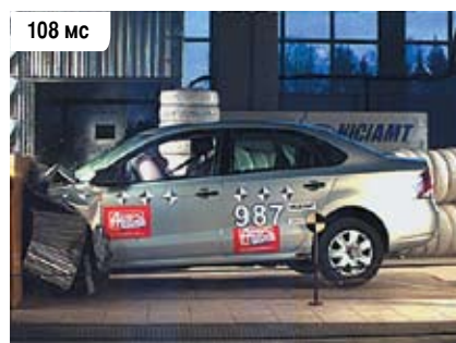
Затем подушка эффективно гасит инерцию тела «водителя» — трехмиллисекундный пик замедления составил неопасные 42,5 g, а НІС — 583 единицы
