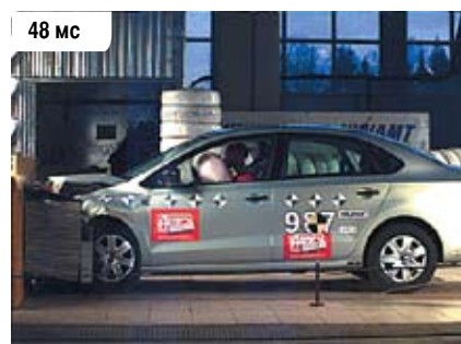
А еще через 20 миллисекунд ее купол уже раскрыт полностью и готов принять голову манекена
