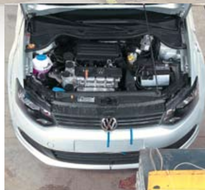
При левостороннем ударе сминаемому барьеру противостоят только левый лонжерон и коробка передач
