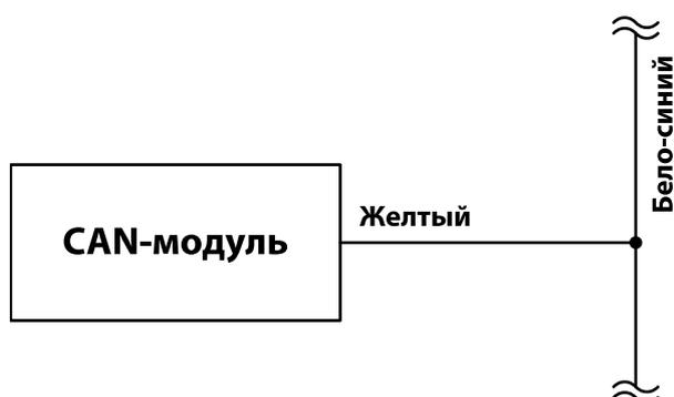
**12.** В жгуте приборного щитка подключаем CAN-шину и контроль стояночного тормоза (Фото 12.1 – 12.2, схема 3).
