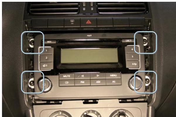
Фото 2.1. Снятие облицовки и саморезы
