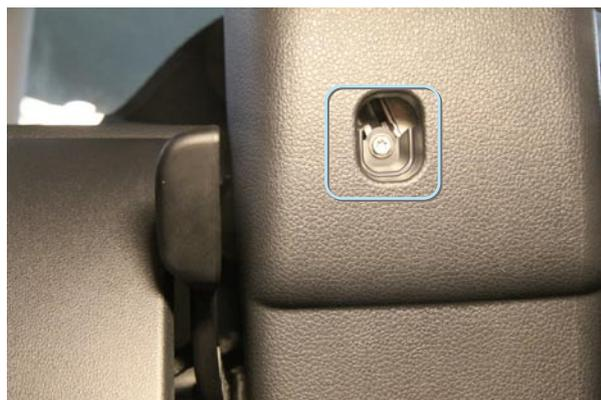
Фото 3.1. Винт крепления нижней части облицовки
