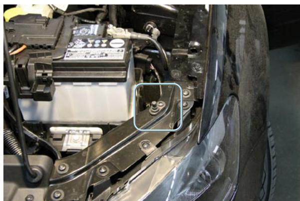
Фото 4.3. Концевик капота. Отрезать 2 деления
