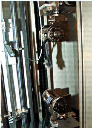
Установки для испытаний на разрыв, изгиб и сжатие развивают усилие от 250 кг до пяти тонн и стоят до 140 тысяч евро
