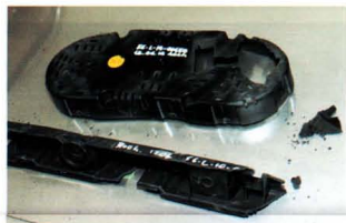
Детали искусственно старят, помещая их на несколько месяцев в «духовку», где поддерживается температура в 100°C. Часть корпуса приборной панели и держатель заднего бампера испытаний не выдержали
