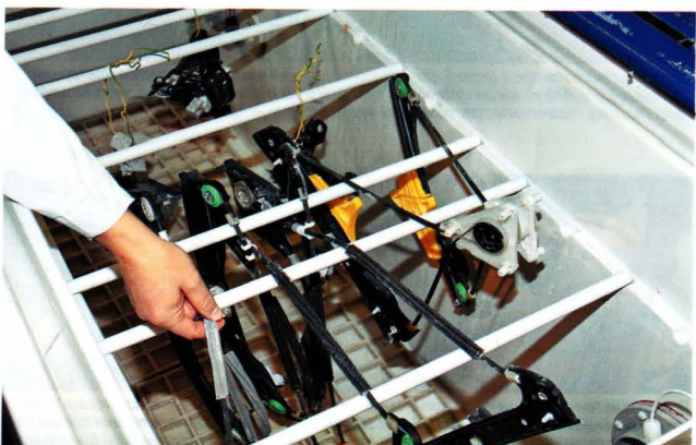
В коррозионных камерах (их здесь три штуки — и каждая стоит по 100 тысяч евро) детали «киснут» до двух месяцев, причем при изменяющихся температуре, влажности и насыщенности солью
