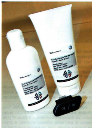
Стойкость покрытия на органах управления испытывают с помощью «фирменной» косметики
