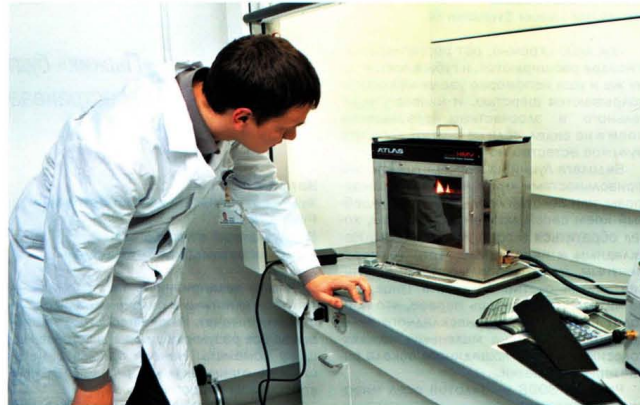
Обивка сидений вообще не должна гореть, а ковер на полу имеет на это право — но со скоростью не более 100 мм в минуту
