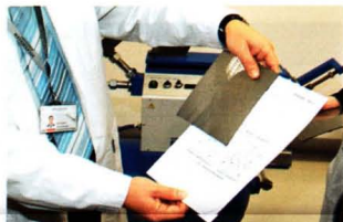
Из пневмопушки Erichsen (на заднем плане) окрашенную поверхность обстреливают дробью, а затем сравнивают характер повреждений с эталоном
