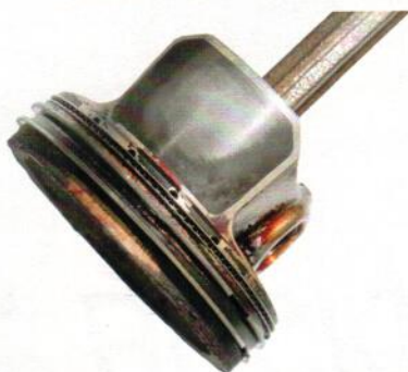
Поршні серии EM: на головке — отгетливыве следы касания о цилиндр
