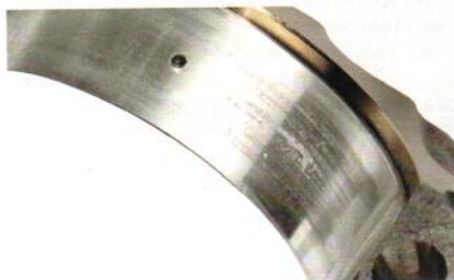
В нашем случае следы на головке едва заметны. Зато юбка поршня потеряла сильное
