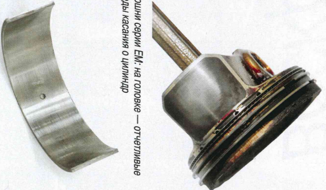
Шатунные вкладыши лишь слегка изношены
