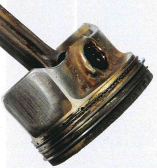
В нашем случае следы на головке едва заметны. Зато юбка поршня потрета сильнее
