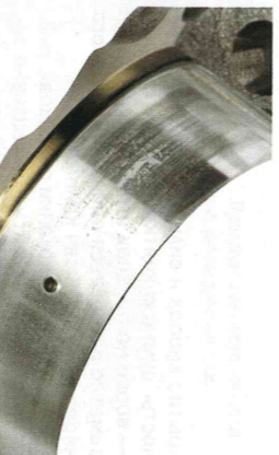
В нашем случае следы на головке едва заметны. Зато юбка поршня потрета сильнее
